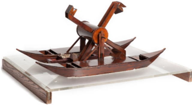
Drague pour curer le fonds boueux d'un canal, maquette de Luigi Tursini d'après le dessin de Léonard de Vinci Milan, Musée national des sciences et des techniques Léonard de Vinci © Musée national des sciences et des techniques Léonard de Vinci
