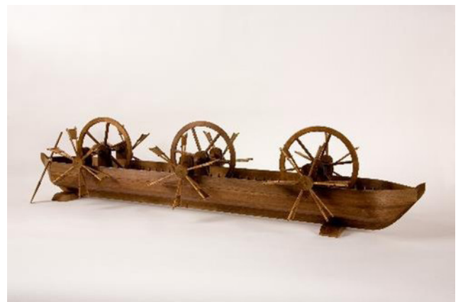
Badalone (navire imaginé par Filippo Brunelleschi pour l'acheminement du marbre sur le chantier du Dôme de Florence), interprétation du département de mécanique et technologies industrielles de l'Université de Florence, Vinci, musée Léonardien © Musée Léonardien
