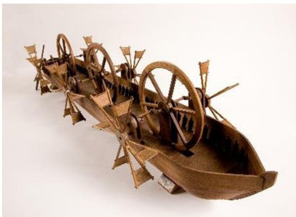
Badalone (navire imaginé par Filippo Brunelleschi pour l'acheminement du marbre sur le chantier du Dôme de Florence), interprétation du département de mécanique et technologies industrielles de l'Université de Florence, Vinci, musée Léonardien © Musée Léonardien
